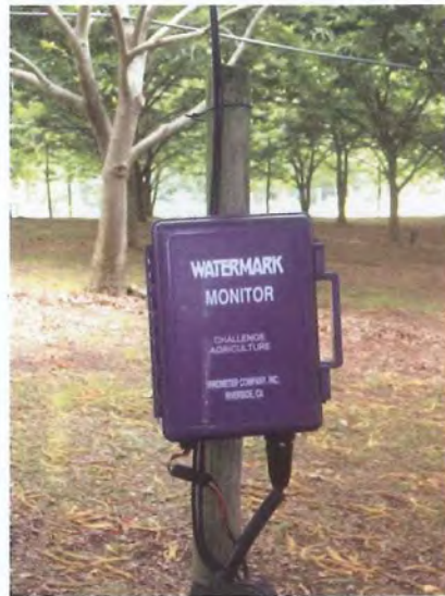
La lecture des données des sondes peut être manuelle (à l'aide d'un boîtier mobile Watermark®), ou automatique (sondes reliées à un boîtier fixe Monitor Watermark comme sur la photo).
